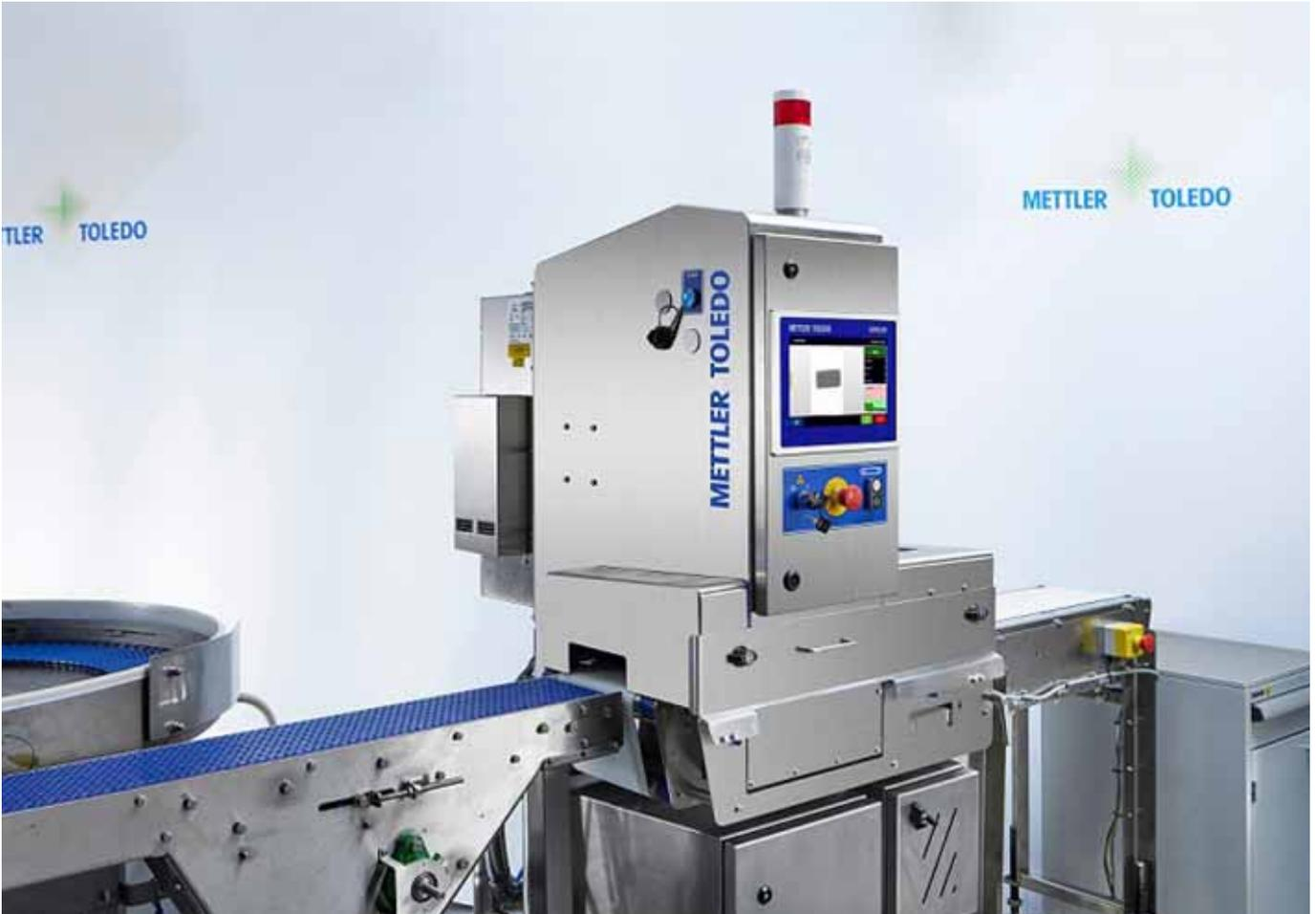
La división Inspección de Productos de METTLER TOLEDO lanza hoy un nuevo sistema de inspección por rayos X, el X34C, que se ha diseñado específicamente para detectar contaminantes en productos envasados pequeños e individuales a gran velocidad.
