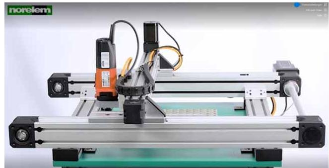
Las poleas dentadas están hechas en aluminio de alta calidad o acero, según el diseño, con las mínimas tolerancias. Las poleas están centradas o pretaladradas. Se pueden mecanizar posteriormente orificios de ajuste y chavetas, si fuera necesario. Además, norelem ofrece ejes dentados con los que se pueden producir poleas dentadas y placas de sujeción propias para sujetar las correas dentadas abiertas.
