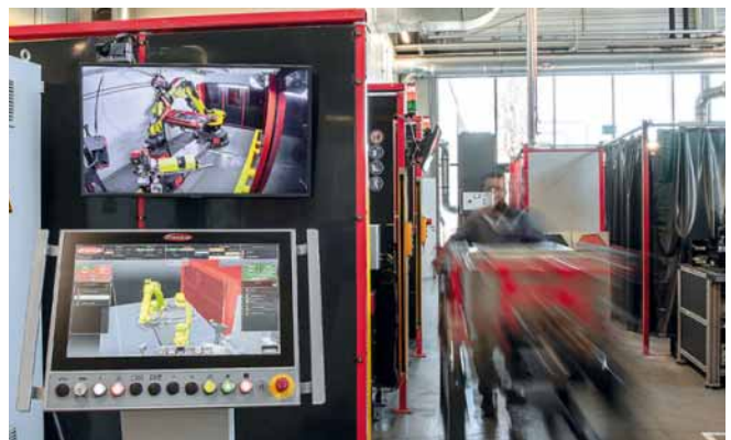
Carga en el útil de sujeción del componente con el carro.
