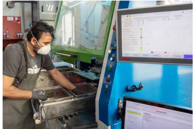
Comprobación de fugas de acuerdo con el grado de protección P65 mediante un sistema de prueba de vacío
