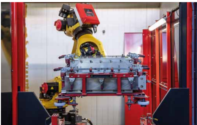
Recogida de componentes con el robot de manipulación Fanuc R-2000iD/210FH.
