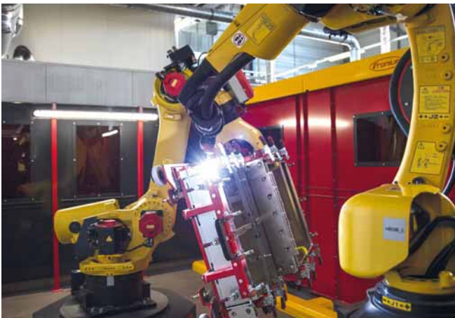
Movimientos sincronizados de los robots Fanuc "Handling-to-Welding" P65 mediante un sistema de prueba de vacío.
