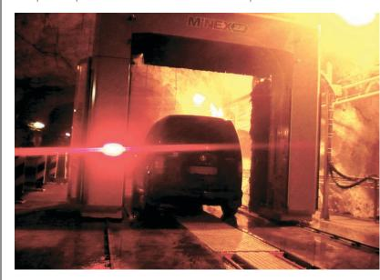
alta presión se limpia la parte frontal, lateral, superior y trasera del vehículo, mientras que los cepillos realizan el lavado del frente, las zonas laterales y trasera de los vehículos. Los técnicos de ISTOBAL tuvieron que realizar un entrenamiento especial para poder trabajar en el interior del yacimiento y completaron la instalación de este puente de lavado en dos semanas.
