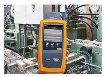
CMATIC, S.L., empresa dedicada a la distribución de soluciones para redes LAN, anuncia la disponibilidad del nuevo DSX-602 CableAnalyzer™ de Fluke Networks, que se convierte en una herramienta esencial a la hora de certificar cableado estructurado de par trenzado de cobre, de Cat 3 / Clase C a Cat 6A / Clase EA.
