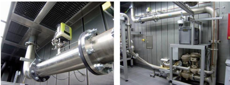
Medición de aire a presión en un banco de prueba de un turbo de un fabricante italiano de coches deportivos.
