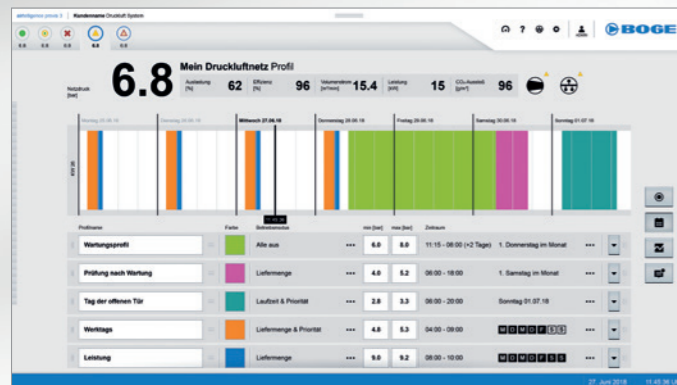
Ejemplo de perfiles de aire comprimido
