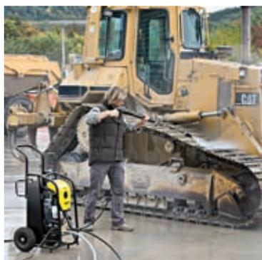
La boquilla turbo de Kärcher combina las ventajas del chorro concentrado y plano. Para una mayor potencia limpiadora y un rendimiento elevado de superficie, el chorro rotativo gira a aproximadamente 4000 r/min sobre su propio eje.
