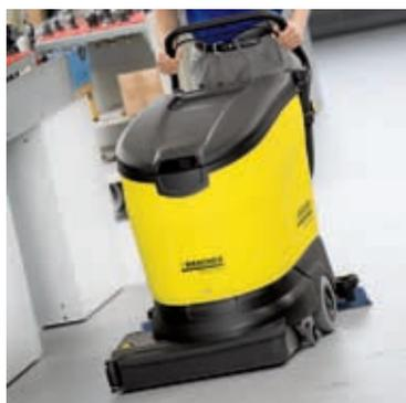
Los labios de aspiración transparentes están fabricados en poliuretano resistente a aceites y al desgaste. Además, son de cuatro usos y están equipados con un límite de desgaste.
