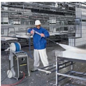
También para las exigencias especiales del sector alimentario, Kärcher ofrece las correspondientes mangueras de alta presión. Las mangueras grises para alimentos de Kärcher poseen una cubierta exterior que no deja marcas. Asimismo, las mangueras para el sector alimentario Longlife con cubierta exterior azul ofrecen otra ventaja: son muy resistentes contra las grasas animales.
