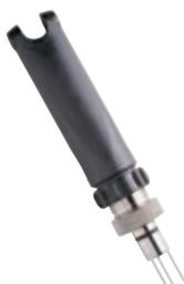
**FLEXIFIT VV**, sonda sanitaria para conexión Varivent (DN40 o DN50). Dos versiones la Flexifit VV-0 recta y la Flexifit VV-15, con conexión inclinada 15° para posicionar el sensor orientado al flujo.
