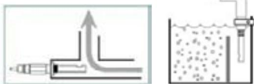
Ejemplos de montaje de células
