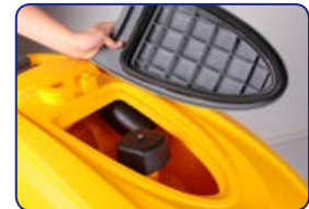
Filtro para partículas grandes + filtro otor de aspiración
