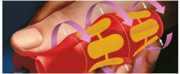
Un contacto casi libre de fricción contra las zonas duras permite cambiar de agarre con gran rapidez.
